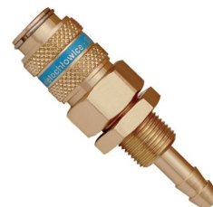
Złączka NW 5,0 z gwintem na przegrodę i choinką na wąż
